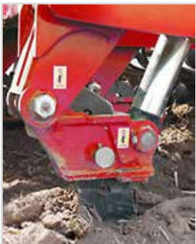
Pro-Fit lazítókések hidraulikus auto-reset késbiztosítással is elérhetőek DTX modellen.
