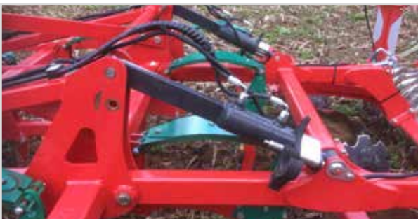
Az Enduro modell hengere nincs párhuzamosan összekapcsolva a vázzal, és a mélység állítása hézagolókkal hidraulikusan változtatható.
