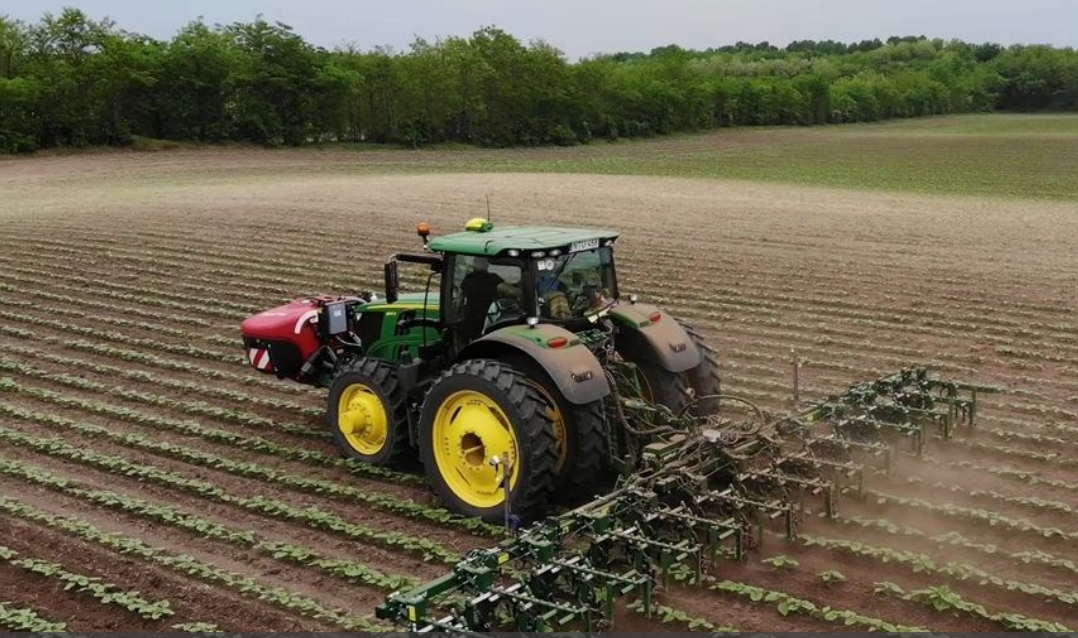
ISOBUS rendszerű, helyspecifikus kijuttatásra alkalmas sávpermetező rendszerrel felszerelt gép, növényvédőszer és folyékony műtrágya kijuttatására
