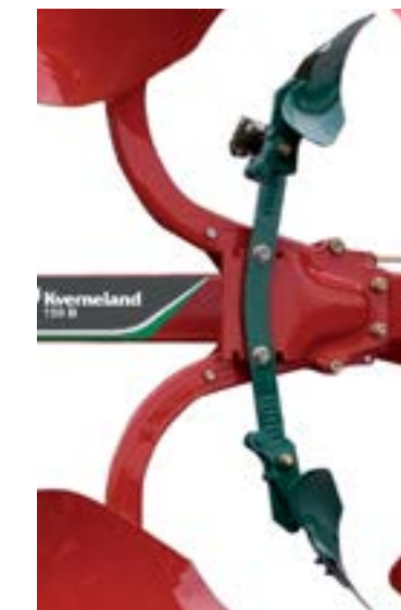
Erős ekeszár: nyírócsapos biztosítás
